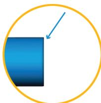
**2 Отметьте на трубе расстояние, на которое труба будет вставлена в соединительный фитинг.**
