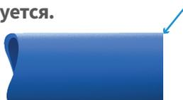
**2 Отметьте на трубе расстояние, на которое труба будет вставлена в соединительный фитинг.**
