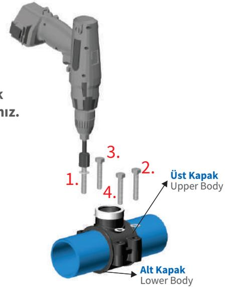
**6 Diş ölçüsüne uygun bir matkap ucu ile ek parçaya değmeyecek şekilde boru delme işlemini gerçekleştiriniz.**
