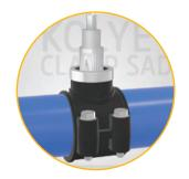
6 Diş ölçüsüne uygun bir matkap ucu ile ek parçaya değmeyecek şekilde boru delme işlemini gerçekleştiriniz.
