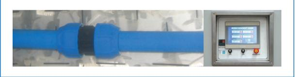
**BÜKÜLÜ İKEN İÇ BASINÇ ALTINDA SIZDIRMAZLIK**Montajlanmış ekleme parçaları, ISO 3503 test standardına göre test edilmektedir.
