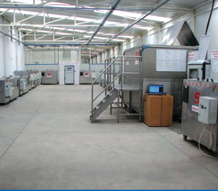
UZUN SÜRELİ İÇ HİDROSTATİK BASINCA DAYANIM TESTİ Priz Kolyeler, ISO 1167-1 test standardına göre test edilmektedir.
